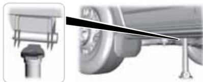
Coloque el cabezal del cricue del vehículo debajo de los salientes de la parte trasera del subchasis delantero.
