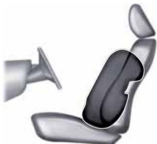
Los airbags laterales se diseñaron para inflarse entre el panel de la puerta y el ocupante para mejorar la protección en determinadas colisiones.
