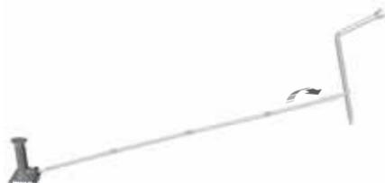
1. Ensamble la palanca del crique.
