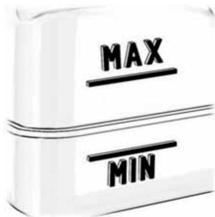
Si el nivel de fluido de la dirección hidráulica está por debajo de la marca **MAX**, agregue un fluido de la dirección hidráulica que cumpla con las especificaciones correctas.
