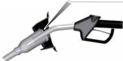
3. Inserte la boquilla del surtidor de combustible hasta la primera muesca de la boquilla A. Manténgala apoyada sobre el revestimiento de la abertura del tubo de llenado del tanque de combustible.
