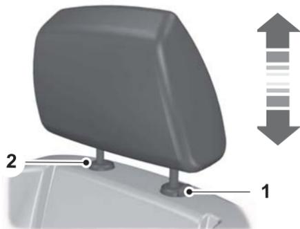
Ajuste el apoyacabeza de manera que la parte superior quede nivelada con la parte superior de su cabeza.
