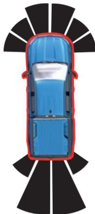
El sistema proporciona una imagen del vehículo y de las zonas de sensores. Las zonas se resaltarán en verde, amarillo y rojo cuando los sensores de ayuda de estacionamiento detecten un objeto en el área de cobertura.
