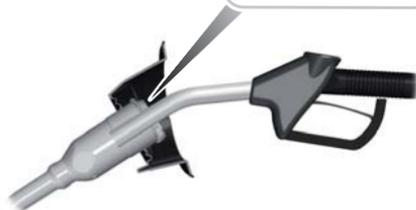
**Nota:** Al insertar la boquilla de la bomba de combustible del tamaño correcto, se abrirá un inhibidor cargado por resorte.
