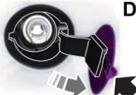
A Tipo 1- Lado izquierdo: presione el tapón de llenado del tanque de combustible para abrirla.
