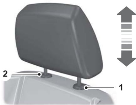
Tire hacia arriba el apoyacabeza. Presione el botón 1 de bloqueo y al mismo tiempo, libere la traba 2 de retención con una herramienta adecuada. Tire el apoyacabeza hacia arriba, hasta que se libere del respaldo del asiento.
