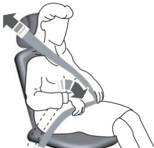
Las mujeres embarazadas siempre deben usar cinturón de seguridad. Ubique la parte del cinturón de la falda en una combinación de cinturón de falda y de hombro en forma baja cruzando la cadera, debajo del vientre y úselo tan apretado como sea posible. Coloque el cinturón para hombro de forma tal que pase sobre la parte media del hombro y por el centro del pecho.
