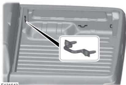
Índice de capacidad de carga de los puntos de anclaje: 300 kg
