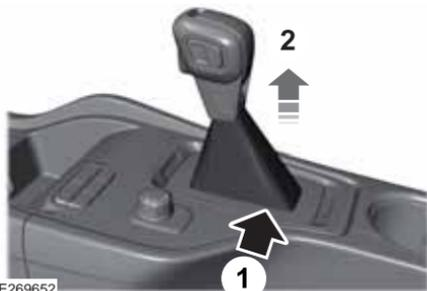
1. Inserte un destornillador entre el material del dispositivo de arranque del cambiador y el anillo de ajuste (1) para soltar las lengüetas de retención desde el anillo de ajuste del panel superior.
