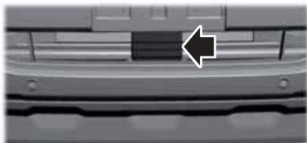
Aparece un mensaje si hay un objeto que obstruye las señales de radar del sensor. El sensor se encuentra detrás de la parrilla inferior. El sistema no puede detectar un vehículo adelante y no funciona cuando hay algo que obstruye la señal del radar.
