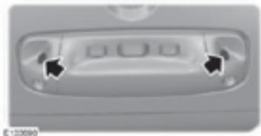
Los sensores interiores se activan al activar la alarma. Véase **Activación de la alarma** (página 32).
