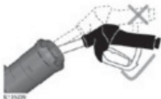
Introduzca la boquilla del surtidor hasta la primera muesca, y manténgala en esa posición en la boca de llenado de combustible.
