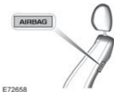
Los airbags laterales van montados en el interior del respaldo de los asientos delanteros. Una etiqueta indica que su vehículo va equipado con airbags laterales.
