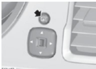
Para plegar y desplegar los espejos retrovisores, pulse el interruptor brevemente. Si vuelve a pulsar el interruptor mientras los espejos retrovisores se están moviendo, estos se detendrán e invertirán la dirección de movimiento.
