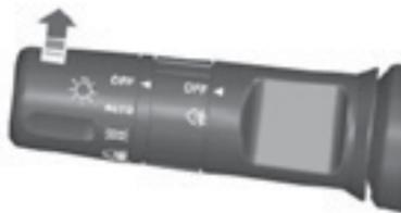
Empuje la palanca hacia delante para cambiar entre luces altas y bajas.
