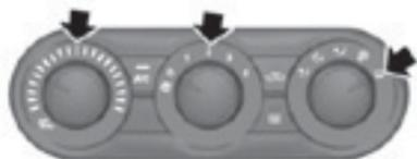
Al seleccionar el aire hacia el parabrisas, se conectará el A/A y seleccionará el aire exterior automáticamente.
