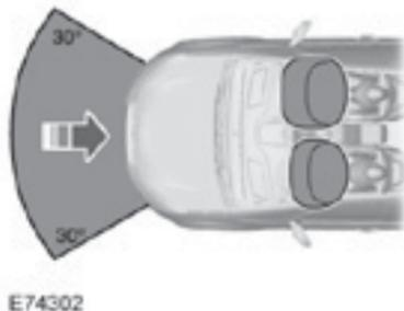
Los airbags del conductor y del acompañante se desplegarán en colisiones frontales considerables o en colisiones hasta 30 grados desde la izquierda o la derecha. Los airbags se inflarán en milésimas de segundo y se desinflarán al contacto con los ocupantes, amortiguando así el desplazamiento del cuerpo hacia delante. En pequeñas colisiones frontales, vuelcos, colisiones traseras y colisiones laterales, los airbags del conductor y del acompañante no se desplegarán.
