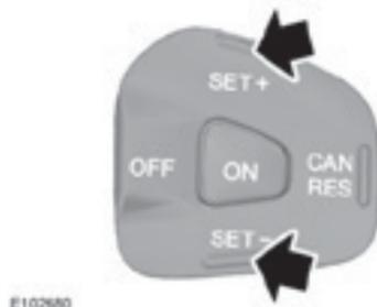
Con el HDC activado, la velocidad de descenso puede modificarse a través de los interruptores de control de velocidad del volante. SET + aumenta la velocidad y SET - la reduce.
