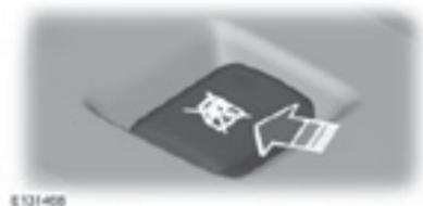
Un interruptor en la puerta del conductor deshabilita los interruptores de los alzacristales eléctricos de los acompañantes.
