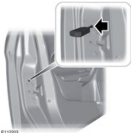
Si la función trabar central no funciona, trabe las puertas una por una con la llave en la posición que se muestra.
