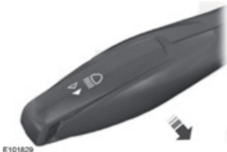
Tire de la palanca por completo hacia usted para encender las luces altas.
