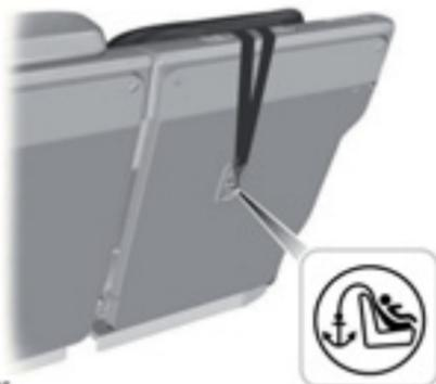
Los puntos de anclaje de las correas superiores se encuentran en la área del baúl, detrás de los respaldos de los asientos de la segunda fila.
