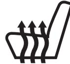
Presione el símbolo de calefacción del asiento en el climatizador o en la pantalla táctil para pasar por las diferentes configuraciones de calor y apagarlo. Mientras más indicadores se muestren, más cálida será la temperatura del asiento.
