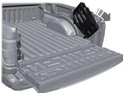
3. Gire los paneles hacia la compuerta. Repita los pasos 1 a 3 en el otro lado del vehículo.
