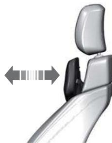
La parte superior delantera del respaldo del asiento se inclina para brindar mayor comodidad. Para inclinar la parte superior del respaldo del asiento, gírela hacia los hombros.
