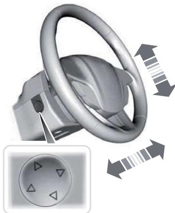
Presione el control para mover el volante hacia arriba o hacia abajo.
