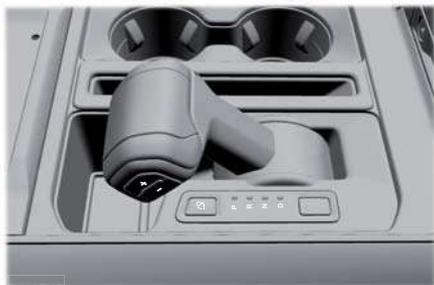
**Nota:** no almacene objetos en el espacio de guardado de la palanca de cambios y asegúrese de que la plancha de la bandeja de la palanca de cambios inferior quede en posición horizontal dentro del lugar de guardado de la palanca.
