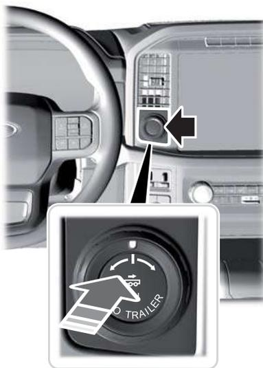
Presione el botón y use la pantalla táctil para seleccionar el remolque conectado.
