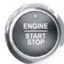
1. Mantenga presionado el botón de arranque hasta que el motor se apague, o presiónelo tres veces en un lapso de dos segundos.
