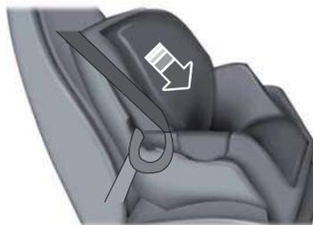
5. Para colocar el retractor en el modo de bloqueo automático, tome la parte del hombro del cinturón de seguridad y tire hacia abajo hasta extraer todo el cinturón.
