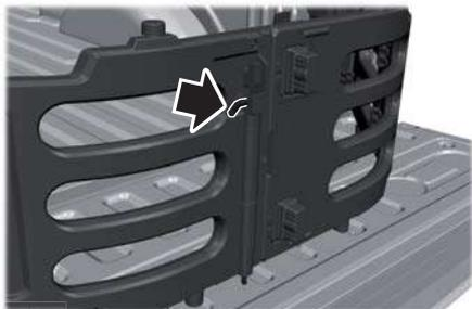
5. Inserte la varilla del pestillo en el orificio de la compuerta.
