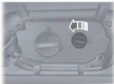
4. Retire la tapa del llenado del tanque del líquido de escape diésel.
