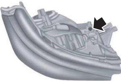
5. Ubique el ajustador vertical en cada óptica delantera. Con un destornillador Philips n.º 2, gire el ajustador hacia la izquierda o la derecha para ajustar la óptica delantera de forma vertical.
