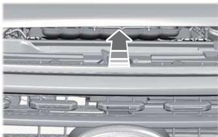
3. Levante el capó hasta que los cilindros de elevación lo mantengan abierto.
