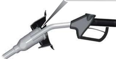
3. Inserte la boquilla de la bomba de combustible hasta la primera muesca. Mantenga la boquilla de la bomba de combustible apoyada sobre el tubo de llenado del tanque de combustible.
