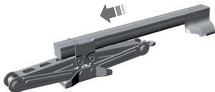
3. Instale la bolsa de herramientas a través del apoyo de carga del crique del vehículo.
