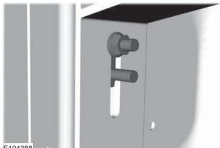
2. Deslice los pasadores del soporte de la rampa hacia arriba, a la posición de instalación.
