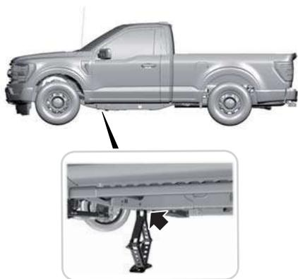
**Nota:** utilice el riel del marco como punto de apoyo delantero para el crিকে, no el brazo de control. El riel del marco está marcado con una flecha.
