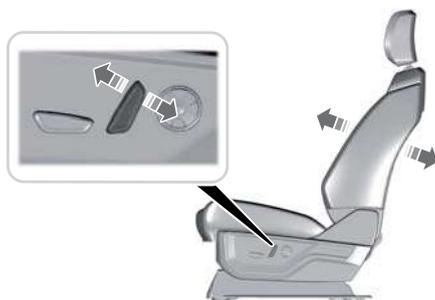
Si reclina totalmente el asiento del pasajero y el vehículo se mueve, aparecerá un mensaje en el cuadro de instrumentos y sonará un tono. Para desactivar la advertencia, vuelva a colocar el asiento en posición vertical.
