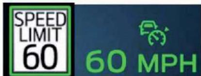
El límite de velocidad establecido se muestra junto al límite de velocidad detectado en el cuadro de instrumentos.
