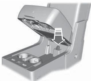
**Nota:** si el vehículo está equipado con el tipo uno, asegúrese de colocar correctamente la llave en la ranura de resguardo.
