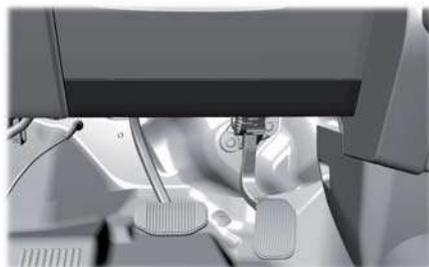
3. Abra cuidadosamente la tapa de acceso con bisagras, usando una cuña de plástico o una herramienta para hacer palanca en el borde superior del panel. Si lo hace correctamente, el panel se inclinará hacia abajo.
