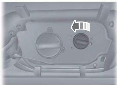
2. Retire la tapa del llenado del tanque del líquido de escape diésel.
