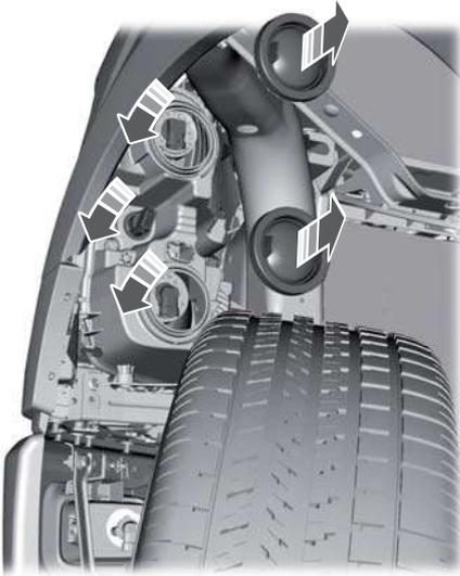
**Nota:** manipule con cuidado las lámparas halógenas de las ópticas delanteras y manténgalas fuera del alcance de los niños. Agarre la lámpara solo por la base de plástico y no toque el vidrio. El aceite de las manos puede causar que la lámpara se rompa la próxima vez que las ópticas estén en funcionamiento.
