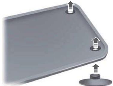
Para instalar las alfombras de piso, coloque el ojal de la alfombra de piso sobre el punto de retención y presione hacia abajo para que se fije en su lugar.
