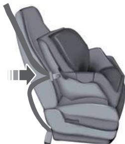
3. Mientras sostiene ambas partes del hombro y de la falda junto a la lengüeta, pase la lengüeta y la correa a través del asiento para niños según las instrucciones del fabricante. Asegúrese de no torcer las correas del cinturón.
