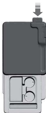
Coloque hacia abajo el pestillo ubicado en la parte superior de la superficie de trabajo para moverla hacia la posición delantera. Existen 11 posiciones en las que se puede trabajar.
