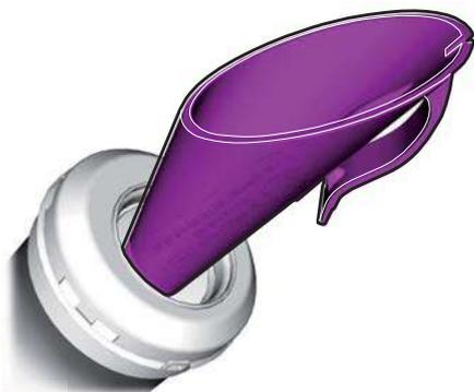
2. Inserte completamente el embudo del tapón de carga de combustible en la entrada de esta.
