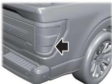
Los sensores se encuentran en la luz del freno en ambos lados del vehículo.
