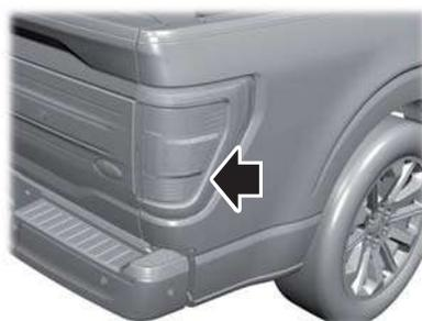
Los sensores se encuentran en la luz del freno en ambos lados del vehículo.
