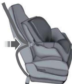
3. Mientras sostiene las partes del hombro y la falda juntas, pase la lengüeta a través del asiento para niños según las instrucciones del fabricante. Asegúrese de no torcer las correas del cinturón.
