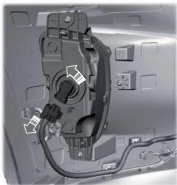
3. Desenchufe el conector eléctrico de la lámpara.
