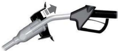
6. Cuando se cierra la bomba, espere 5 segundos; luego, levante un poco la boquilla de la bomba de combustible y quítela lentamente.
