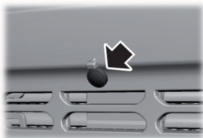
La cámara de estacionamiento delantera se ubica en la parrilla. La cámara proporciona una imagen de video del área ubicada delante del vehículo.
