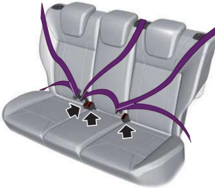
Tire el cinturón de seguridad de manera continua para desenrollarlo. Si tira bruscamente o si el vehículo se encuentra en una pendiente, el cinturón de seguridad puede quedar trabado.
