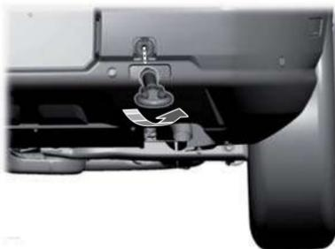
1. Retire suavemente la cubierta de la punta del gancho de remolque frontal y trasero.
