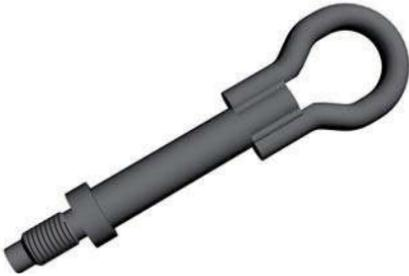
El gancho de remolque se encuentra en la bandeja de almacenamiento de la rueda de auxilio. Si el vehículo no tiene un gancho de remolque, puede comprar uno en su concesionario.
