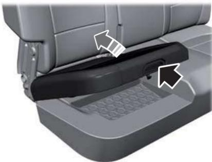
Empuje el pestillo y levante la parte inferior del asiento para acceder al compartimento de almacenamiento.
