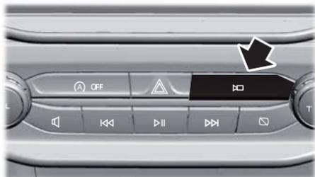
El botón del sistema de cámara se encuentra en la unidad de audio y le permite activar y desactivar la cámara delantera.
