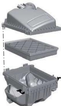
7. Coloque el filtro de aire nuevo. Tenga cuidado de no doblar los bordes del filtro contra el compartimento o la cubierta del compartimento del filtro de aire. Esto puede dañar el filtro y permitir que aire no filtrado entre al motor si no está asentado de manera adecuada.
