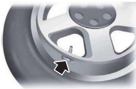
**Nota:** cada neumático cuenta con un sensor de presión de neumáticos ubicado en la cara interior de la rueda. El sensor de presión está unido al vástago de la válvula. Este sensor está cubierto por el neumático, por lo que no está a la vista a menos que retire el neumático. Tome debida precaución al cambiar los neumáticos para evitar dañar el sensor.
