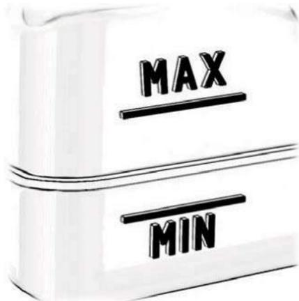
Para evitar la contaminación del líquido, el tapón del depósito de líquido debe permanecer en su lugar y bien ajustado, a menos que esté agregando líquido.
