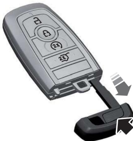
La llave de acceso inteligente hace funcionar los seguros eléctricos y el sistema de arranque a distancia. La llave debe estar en el vehículo para poder usar el botón de arranque.
