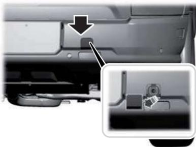
1. Con una herramienta apropiada, como un destornillador, tire desde el borde superior de la cubierta del gancho de remolque.
