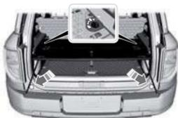
1. Deslice el separador del baúl a la primera posición de fijación.
