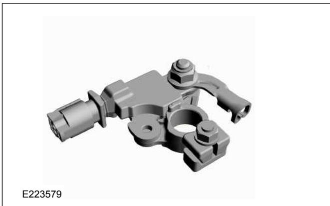
Los vehículos Ford Ranger están equipados con una función llamada sistema de monitorización de la batería (BMS). Este sistema mide la carga de la batería para determinar eficazmente el nivel de carga y mejorar, así, el consumo y las emisiones de combustible.
